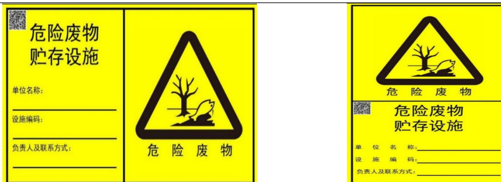
横版危险废物贮存设施标志样式示意图 竖版危险废物贮存设施标志样式示意图 危险废物暂存场所贮存设施内部分区标志：
