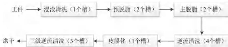
**图 2-4 工件表面处理工艺详细流程图**
