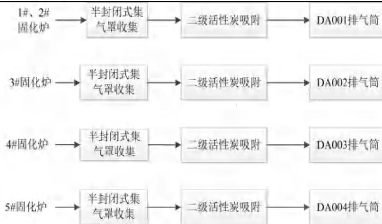
图 4-2 废气收集处理流程图
