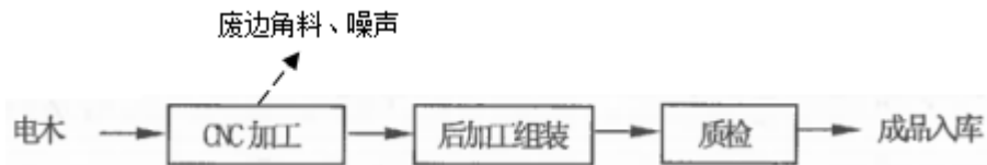
图 2-15 非标工装夹具（三期在建）生产工艺流程图
