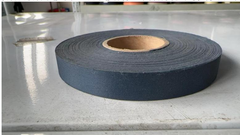
注2：本项目使用布胶为聚乙烯与纱布纤维的热复合，本身不具有粘性，加热后，纱布纤维中的聚乙烯成分熔融，冷却后粘结具备一定硬度，不属于胶黏剂。
