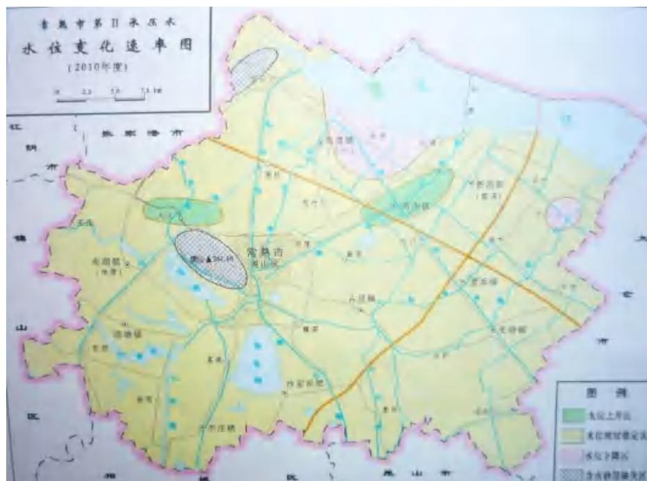
图 5.1.6-2 第II承压水水位变化速率
