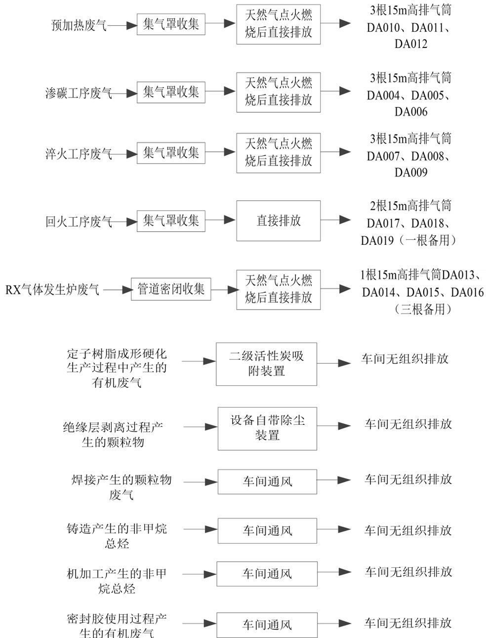
图 2-16 现有项目废气走向图
