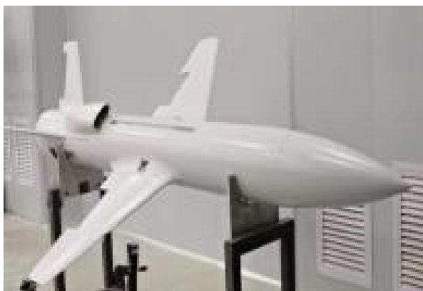
图 2-1 航空器复合材料整机结构产品示意图
