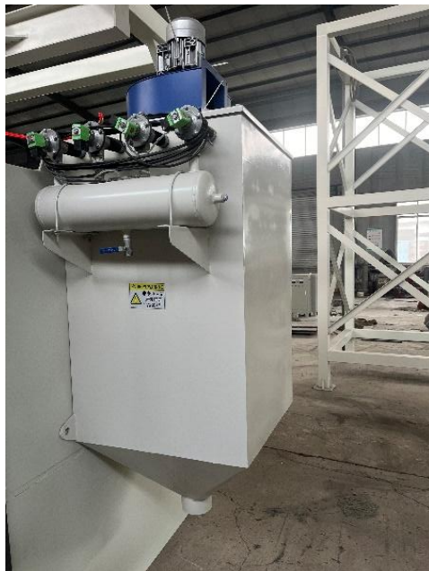
混合机布袋除尘器
