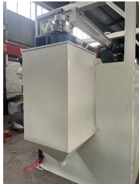
拆包站布袋除尘器
