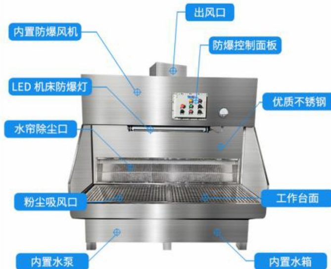
图 4-5 本项目打磨湿式除尘结构图
