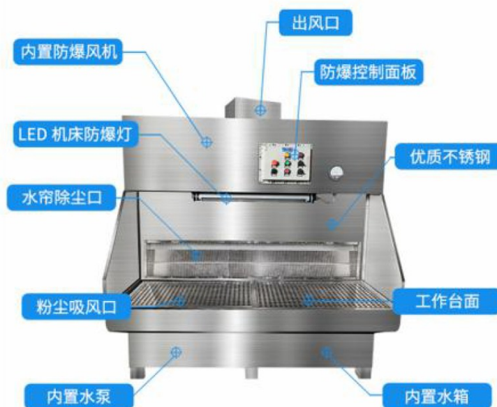
图 6.1-5 本项目打磨湿式除尘结构图
