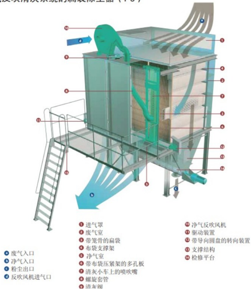
图 4-2 本项目扁布袋除尘器结构图
