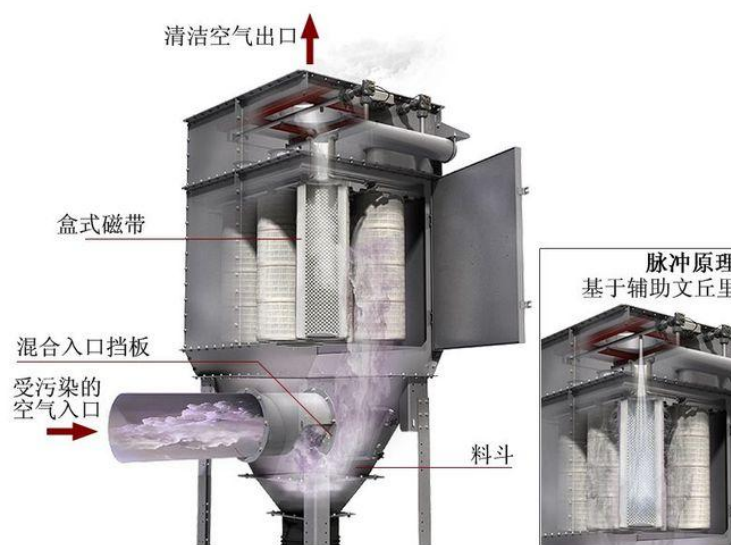
图 4-2 脉冲反吹滤筒除尘器设备示意图
